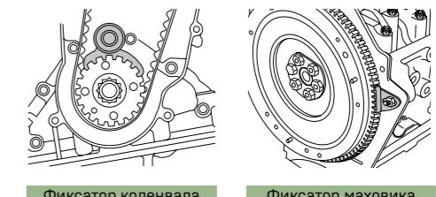
Фиксатор коленвала | Фиксатор маховика
